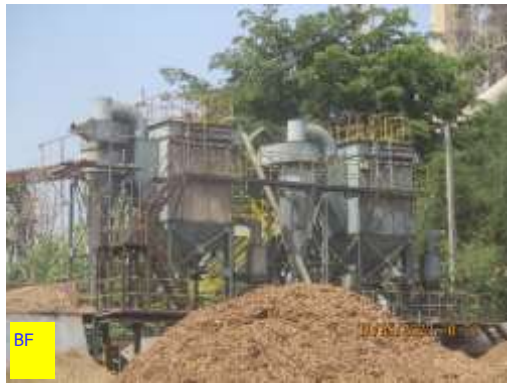
ภาพที่ 2.3 อุปกรณ์บำบัดฝุ่นชนิดถุงกรอง (BF) และระบบไฟฟ้าสถิตย์ (EP)
