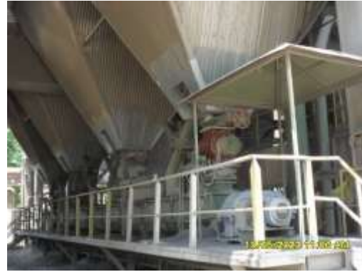
ภาพที่ 2.34 ที่เก็บเฝ้าจากระบบบำบัดมลพิษทางอากาศบริเวณใต้ EP
